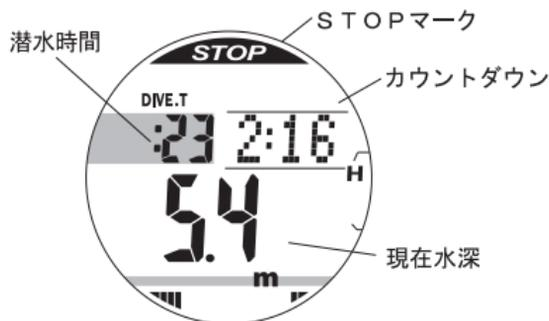
水深10m以深に潜水した後、無減圧潜水状態で浮上すると、水深6.5m時点から3分間のタイマーが自動作動し、水深1.0m~9.9mに停滞している間は続きます。この3分間のカウントダウンが終了するまでは、水面に浮上しないで「安全停止」を行うことを推奨します。
