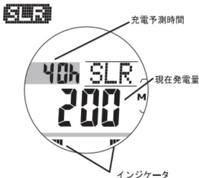
時計モードまたは、サーフェイスモードからMボタンを8回または7回押してソーラー発電量表示モードにします。
