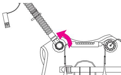
4 コンビネーションバルブを下向きにして、ブランケットの12角形になっている凸部と凹部の角を合わせてねじ込みます。
