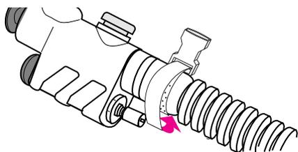
3 ブランケットのネジを緩めてコンビネーションバルブを取り外します。
