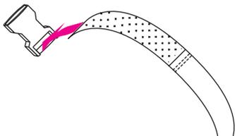
2 ジャバラベルトをコンビネーションバルブのジャバラホースに取り付け、マジックを貼り合わせます。
